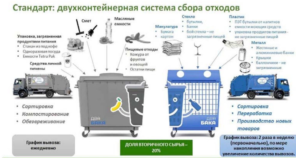
Рисунок 3.60 – Схема двухконтейнерной системы сбора отходов
